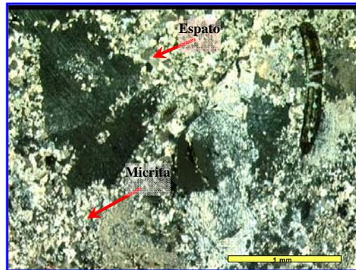
**Figura 3.44** Microfotografía matriz de micrita y cemento carbonático en muestra de litofacies C, carbonato puro.
