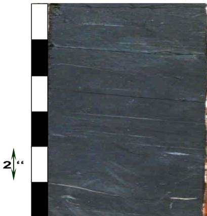
**Figura 3.17** Litofacie L, Arcillitas finamente laminadas en ocasiones arenosas.
